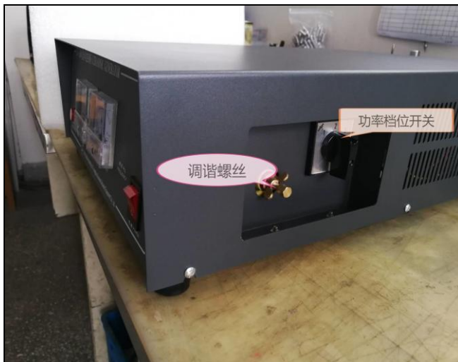
2000 型超声波模拟电源的外表特征和功能（上图）
