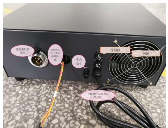
2000 型超声波模拟电源的外表特征和功能（上图）
